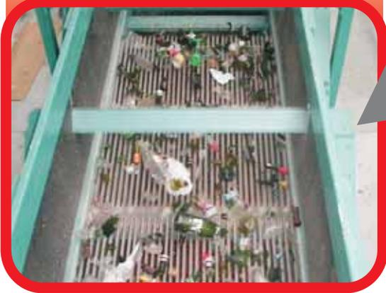
Auf einem Förderband gelangt das grob vorsortierte Material nun in die Fabrik. Über diesem Förderband befindet sich ein großer Magnet, dieser holt alle Teile die aus Metall sind heraus.
