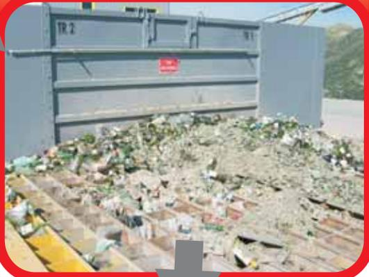
Nun befindet sich das Material auf dem sogenannten Stangenrostsieb. Alles was über das Stangenrostsieb befördert wird, muss von einem Doppelwalzenbrecher zerbrochen werden.
