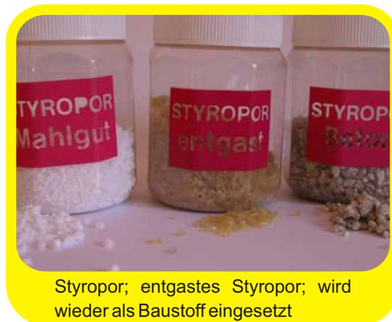
Styropor; entgastes Styropor; wird wieder als Baustoff eingesetzt
