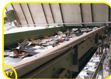
Material bewegt sich zur Cartago-Maschine, die die restlichen Kartons aus dem Papier rausschießt.
